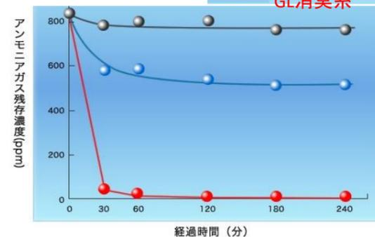
①アンモニアガス100ppmを充填した試験では、糸1gの投入で約30分～60分で、ほぼアンモニアガスの残存が見られないレベルにまで消臭をした。
